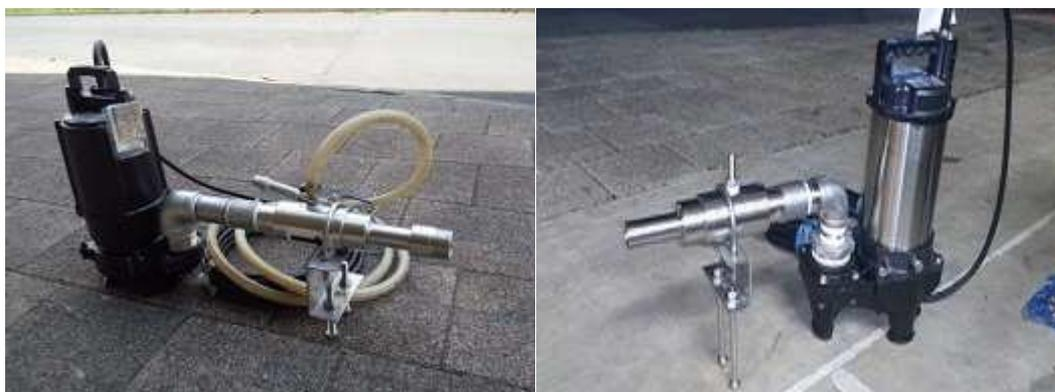
常識的にはYJノズルの酸素溶解効率を50%として、6.9m<sup>3</sup>/minの純酸素が必要酸素量として必要ですが、今回の場合、YJ-21(100/min)×12本=1.2m<sup>3</sup>/minの酸素でBOD負荷5,000kg・BOD/日を分解しており、これは常識的に必要な必要酸素量のわずか1/5以下にすぎないことが分かります。
